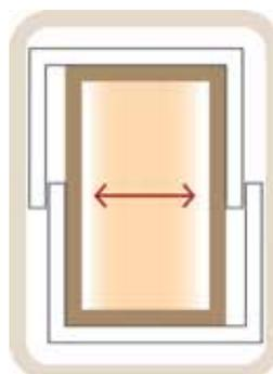
*Die doppelte Folienüberlappung sorgt für eine schnelle Entlüftung und verbessert den Feuchtigkeitsschutz deutlich.*
