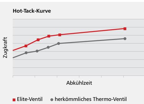
Der Hot-Tack (Warmnahtfestigkeit) kennzeichnet die Festigkeit der Naht unmittelbar nach Beendigung eines thermischen Fügevorgangs.
