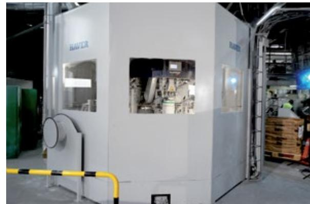
*Die rotierenden Packmaschine ROTOSEAL-PACKER von Haver & Boecker mit Ultraschallverschleißtechnik stehen für eine extrem saubere Produktabfüllung und ein optimales Verschleißergebnis durch Vermeidung von Produktansammlungen im Ventilbereich.*
