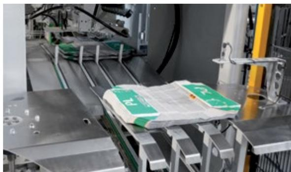
Für Schönox schlug dy-pack einen Papierventilsack vor, der zum Teil mit Tragegriffen (bis 20 kg), dem LEOS-Öffnungssystem und einem überlappenden Folienkonzept ausgestattet ist.
