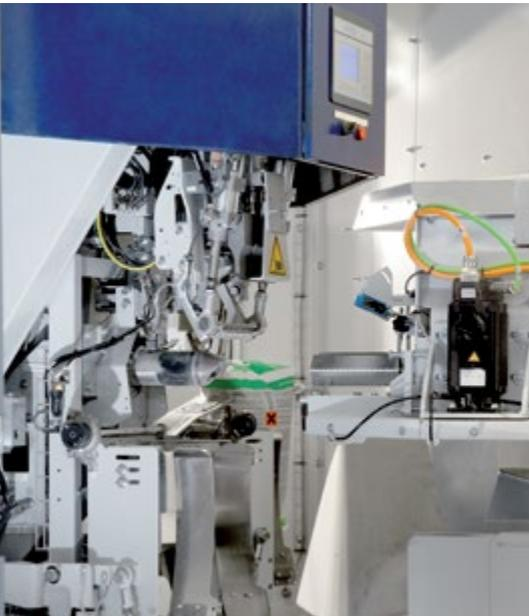
*Die Anlage verfügt über eine vollautomatische Umstellung und automatische Reinigungsprogramme. Dadurch ist ein Produktwechsel inzwischen sehr schnell möglich.*
