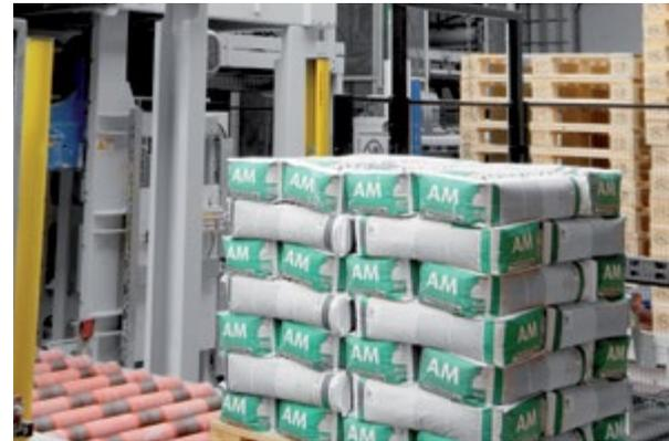
*Die schnelle Ableitung der Luft beim Befüllen steigert die Abfüll-Leistung und erhöht die Genauigkeit der Füllmengenbestimmung. Zudem ermöglichen die perfekt gefüllten, formstabilen Säcke eine ideale Warenpräsentation auch auf Paletten.*
