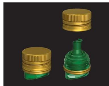
Il s'agit là d'un excellent exemple du fait que l'on peut combiner deux matériaux, en l'occurrence, le plastique et l'aluminium, pour réaliser un système d'emballage novateur et efficace. Le bec verseur peut s'adapter à la gamme standard de capsules en aluminium destinées aux huiles. Ce dispositif a été conçu spécifiquement en fonction de la viscosité de l'huile, tandis que le contrôle du dosage s'effectue via un système de bec verseur télescopique spécial qui se déploie à chaque ouverture.
